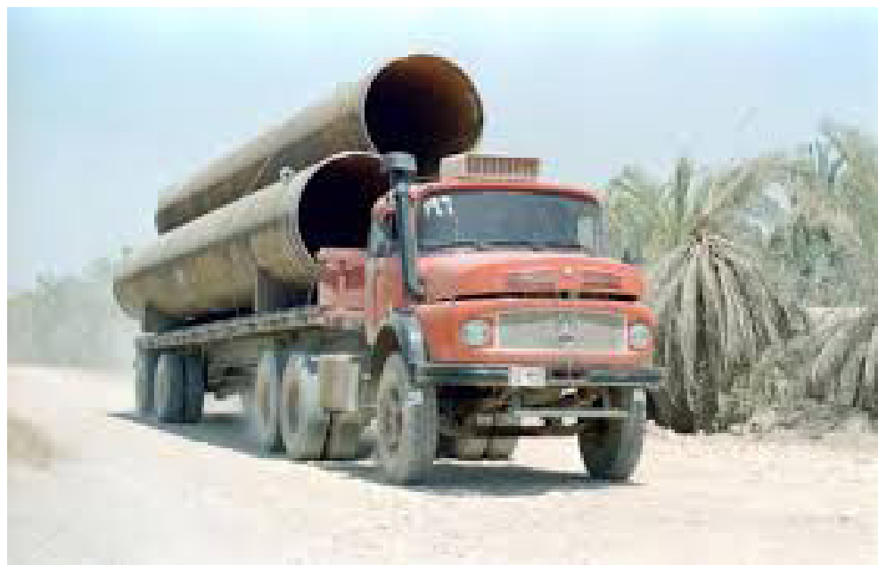
■ مراحل ساخت پل لوله‌ای بعثت بر روی اردو درود با عرض ۹۰۰ متر، با ۵۰۰۰ قطعه لوله ۱۲ متری با قطر ۱۴۲ سانتی متر و وزن ۷ تن
