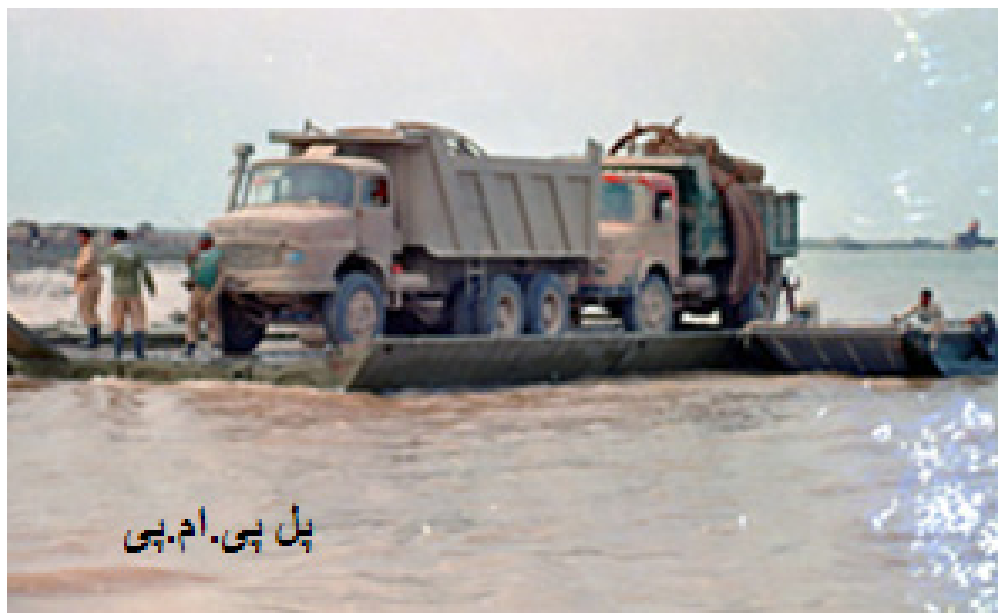
■ طراده سنگین با استفاده از سطوحهای پل شناور پی.ام.پی
