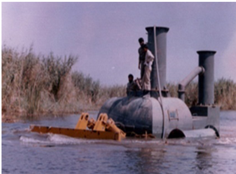
۱ - مینی لندینگ: دستگاهی است که در داخل آب برای کشیدن و هُل دادن ده‌ها قطعه پل شناور از آن استفاده می‌شد.
