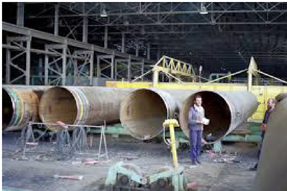
■ مراحل ساخت پل لوله‌ای بعثت بر روی اردو درود با عرض ۹۰۰ متر، با ۵۰۰۰ قطعه لوله ۱۲ متری با قطر ۱۴۲ سانتی متر و وزن ۷ تن
