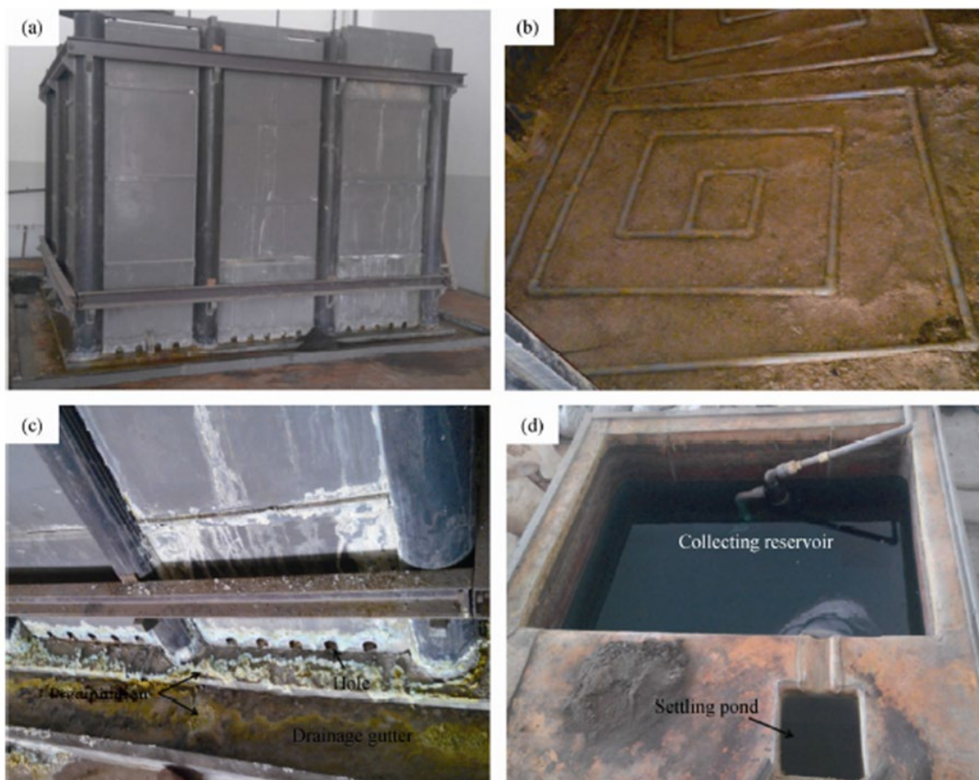
شکل (۱-۲۳) - هیپ بیولیچینگ: (الف) راکتور هیپ بیولیچینگ، (ب) ترتیب خط لوله هوادهی، (ج) ناودان زهکشی؛ (د) استخر ته‌نشینی و مخزن جمع‌آوری [۲۸]
