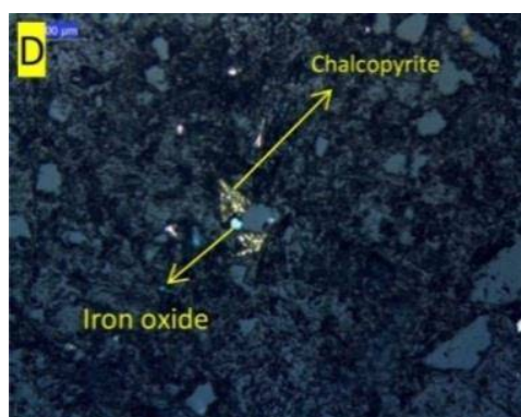
شکل ۸: (D) حضور کالکوپیریت و اکسید آهن در باطله ها، (F) حضور پیریت و اکسید آهن در باطله ها.
