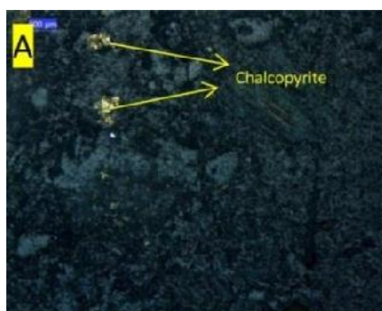
شکل ۶: (A) حضور کالکوپیریت در باطله ها، (B) حضور کالکوپیریت و پیریت در باطله ها
