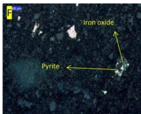
شکل ۸: (D) حضور کالکوپیریت و اکسید آهن در باطله ها، (F) حضور پیریت و اکسید آهن در باطله ها.
