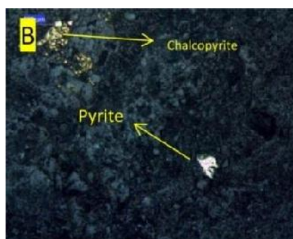
شکل ۶: (A) حضور کالکوپیریت در باطله ها، (B) حضور کالکوپیریت و پیریت در باطله ها
