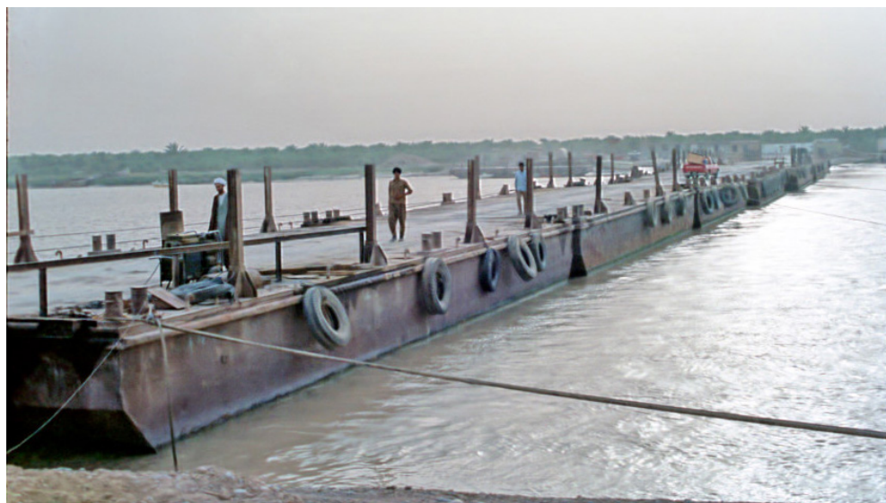
پل شناور دوبه‌ای - اهواز، رودخانه کارون
