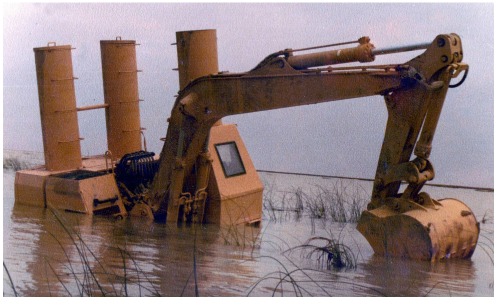
بیل مکانیکی دوزیست باتلاق روابتکاری
