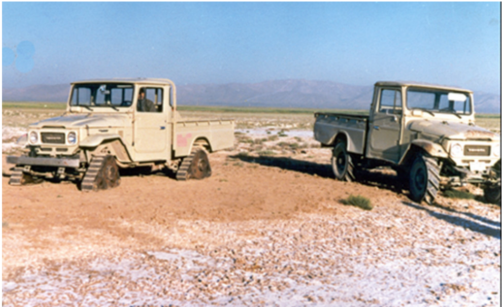
ابتکاری برای عبور خودروهای سبک در زمین‌های باتلاقی
