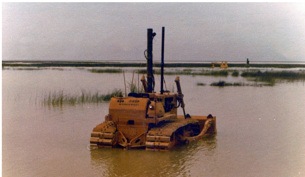
بلدوزر ویل مکانیکی دوزیست باتلاق رو ابتکاری
