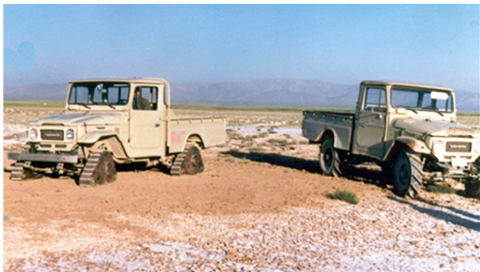
ابتکاری برای عبور خودروهای سبک در زمین‌های باتلاقی
