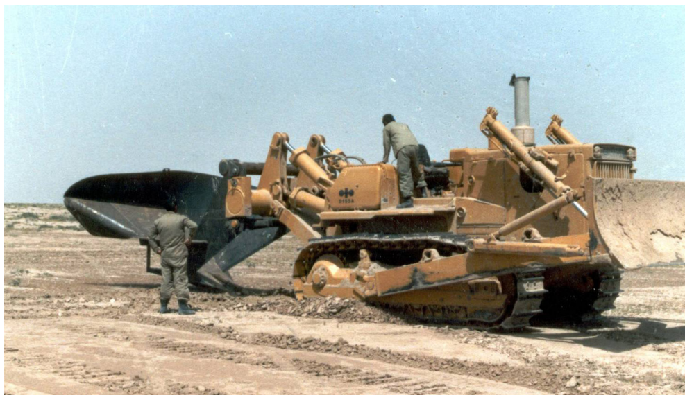
ساخت دستگاه نهرگن (کانال کن)
