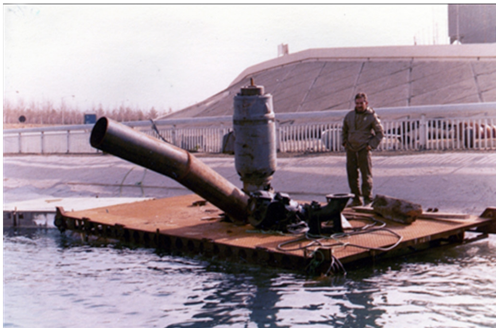
ساخت دستگاه پمپاژ آب برای تخلیه و هدایت مناطق آب‌گرفتگی (محل آزمایش دریاچه ورزشگاه آزادی تهران)
