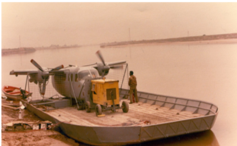
طراده خودکشی، با استفاده از نیم تنه هواپیمای اسقاطی و موتورهای توربوفن آن، برای عبور از اروند
