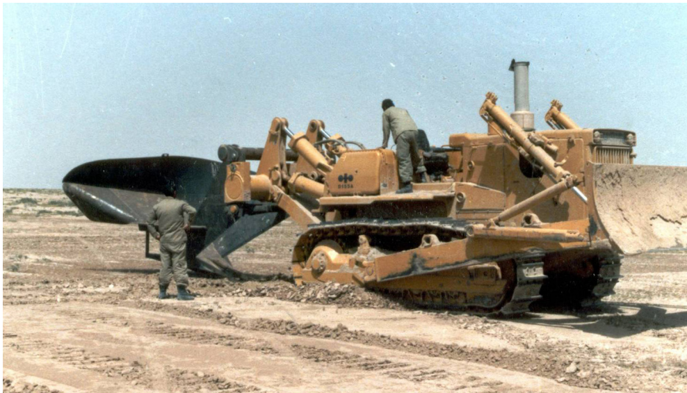
ساخت دستگاه نهرگن (کانال کن)
